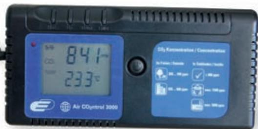
(1) Ein  $\text{CO}_2$ -Gerät deckt Probleme mit der Luftqualität schnell auf. Hier jedoch, bei 841 ppm, liegt man noch im grünen Bereich.
