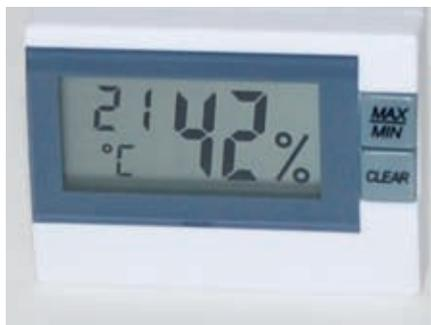
(4) Wenn die Lüftungsanlage über eine Feuchterückgewinnung verfügt, sinkt die Luftfeuchtigkeit auch bei Frostwetter kaum unter 40 %, selbst wenn es wenig Feuchtelasten im Haus gibt.
